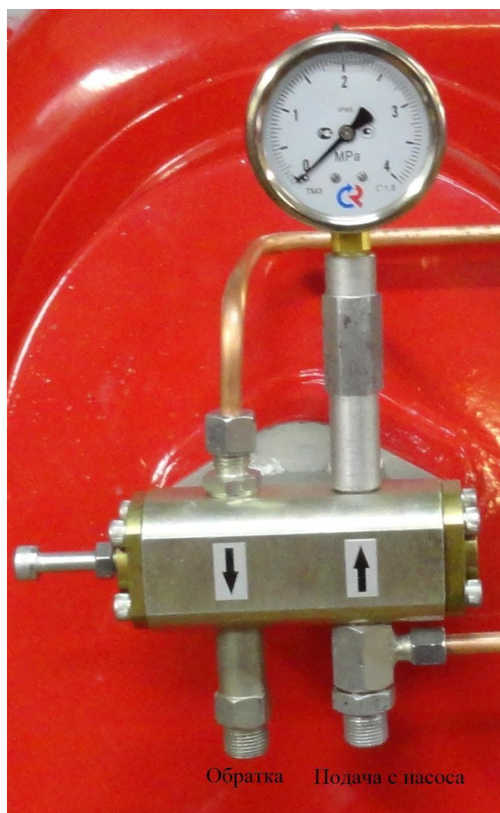
Рисунок 19 - Схема подключения насосной станции к горелки. На рисунке 20 показано подключение топливных шлангов горелки к ВНС
