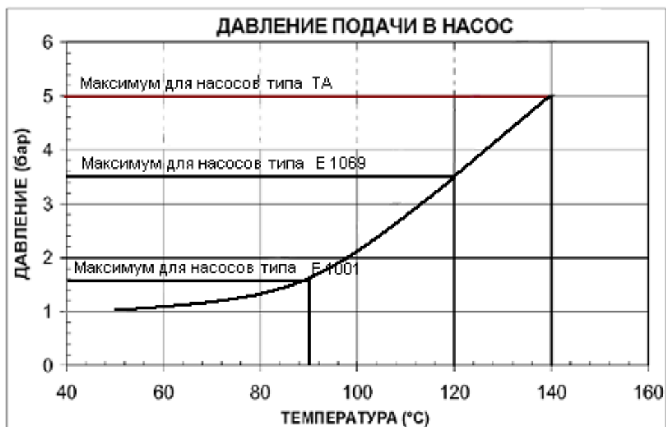
График 3 - Предельные параметры топлива для насосов
